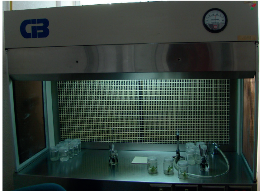
Figura. 2. Campana de flujo laminar, es un equipo importante para el desarrollo de la técnica de cultivo de tejidos en condiciones asépticas, ya que permite obtener una zona estéril y segura libre de microorganismos.
