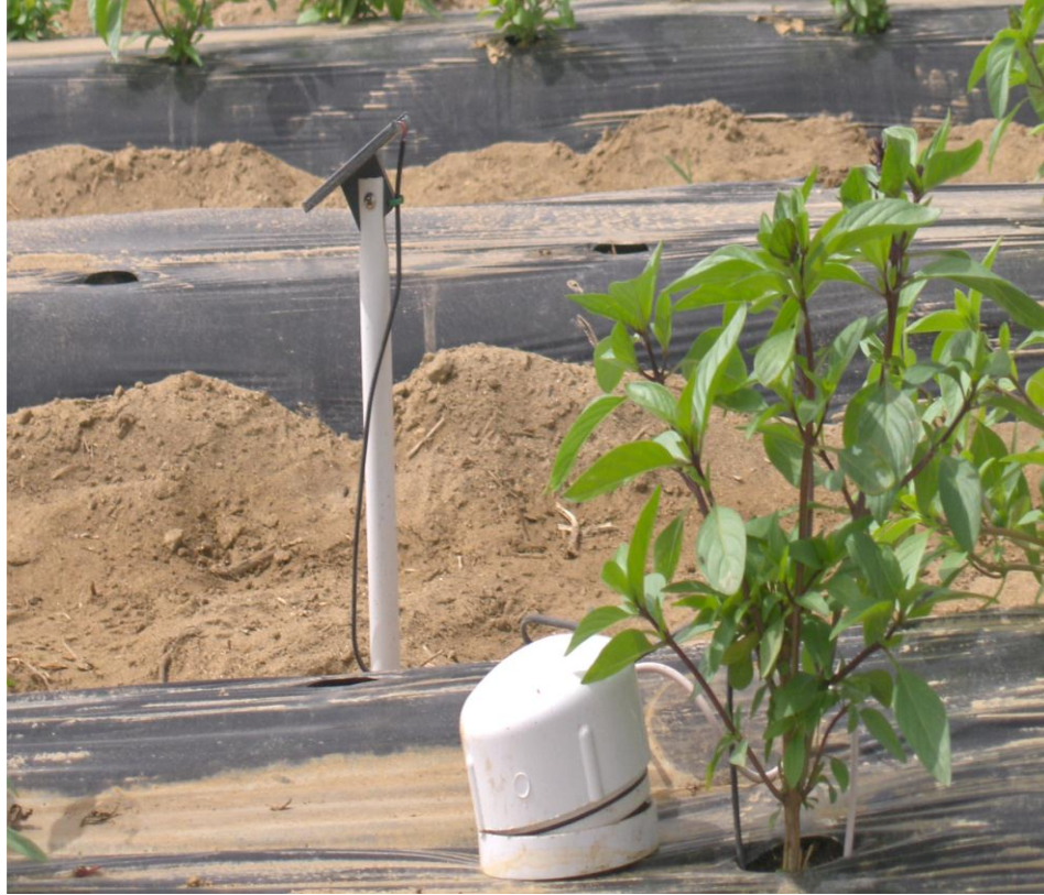
Figura 13. Orientación del panel solar de la unidad de sensores inalámbricos.
