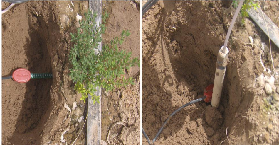
Figura 11. Sensores de humedad y temperatura en la zona radicular.
