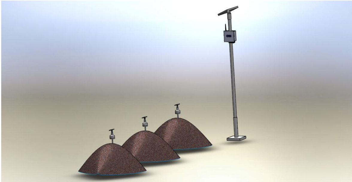
Figura 3. Configuración del sistema inalámbrico de medición de temperatura de composta.
